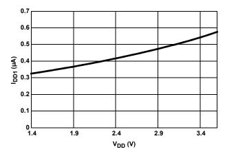
FIGURE 2. I<sub>DD1</sub> vs V<sub>DD</sub>
