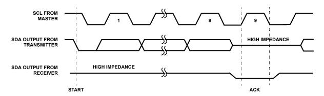
FIGURE 8. ACKNOWLEDGE RESPONSE FROM RECEIVER
