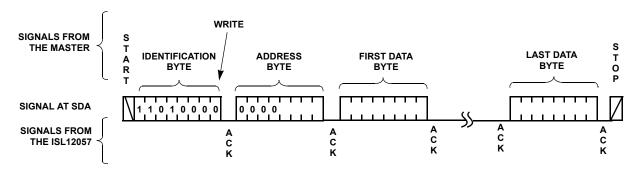
FIGURE 9. SEQUENTIAL BYTE WRITE SEQUENCE
